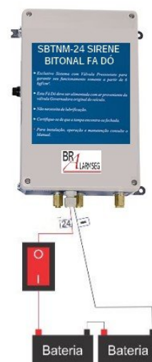
Diagrama característico de instalação elétrica do sistema 24vcc
